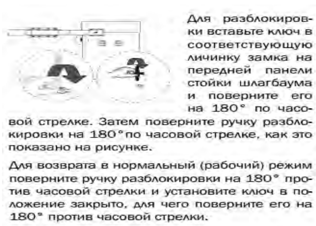
Рис. 5. Разблокировка привода с помощью ключа для разблокировки
